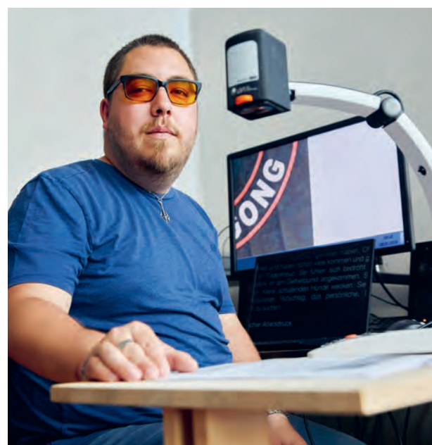
Das Lesesystem mit externer Kamera kommt bei Schriftstücken auf Papier zum Einsatz.
